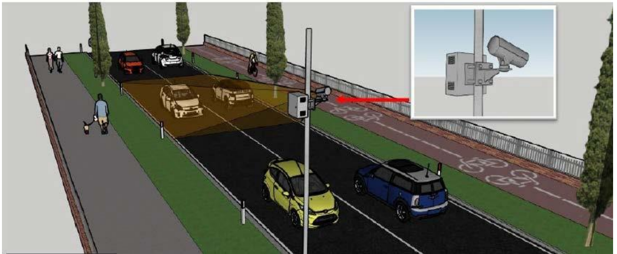
La Fig. 3 mostra le migliori condizioni per una lettura su doppia corsia. Nel caso del senso unico di marcia la situazione migliore la si ha quando la telecamera è installata su portale e puntata verso le targhe frontali in avvicinamento
