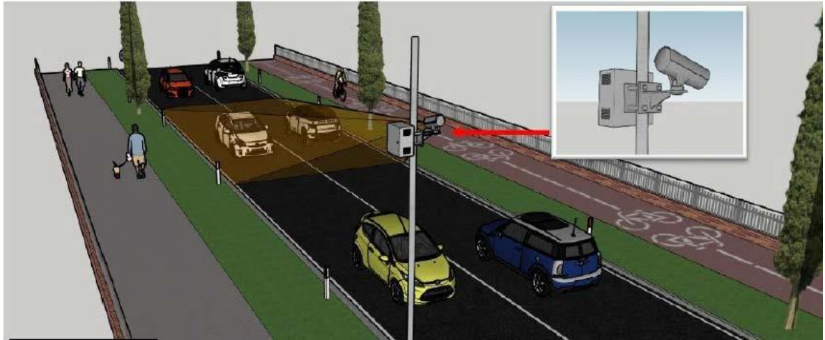
La Fig. 3 mostra le migliori condizioni per una lettura su doppia corsia. Nel caso del senso unico di marcia la situazione migliore la si ha quando la telecamera è installata su portale e puntata verso letarghe frontali in avvicinamento
