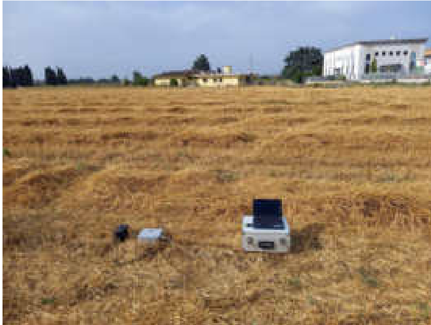
Foto n.2 : stazione sismica di tipo H.V.S.R.
